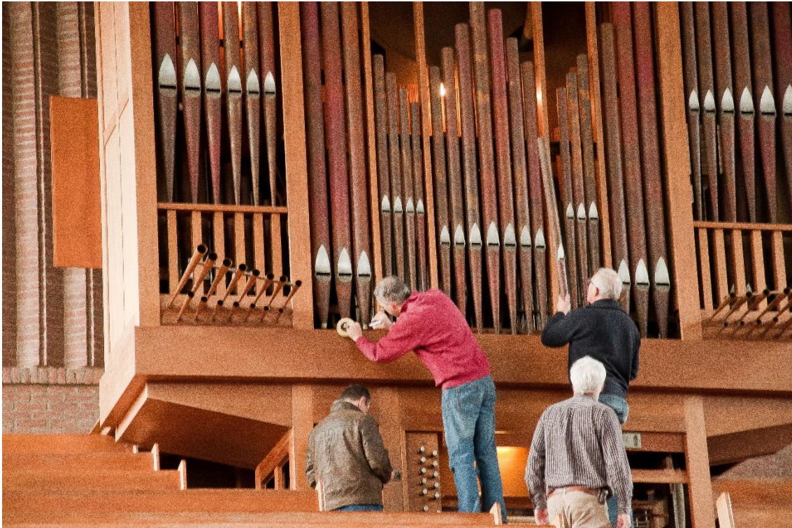
Figuur 8 pijpen nummeren en druk meten
