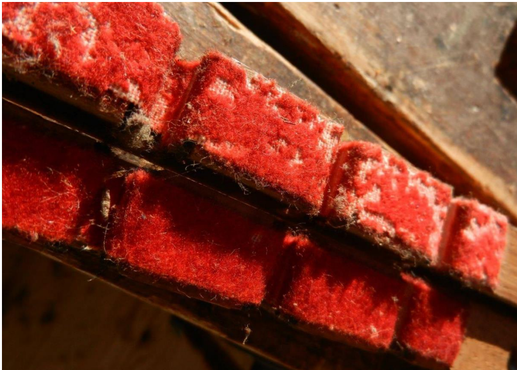
Figuur 37 Vergane pedaal klavier invoeringen.
