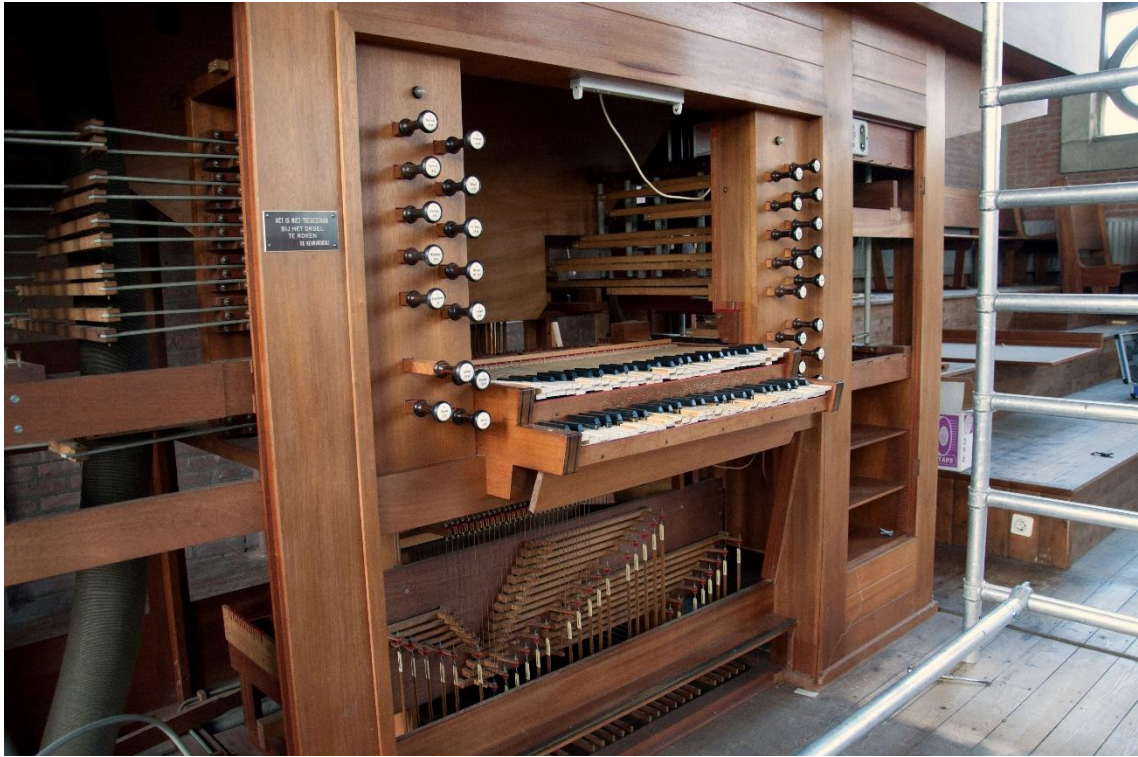
Figuur 18 de speeltafel wordt verder ontkoppeld
