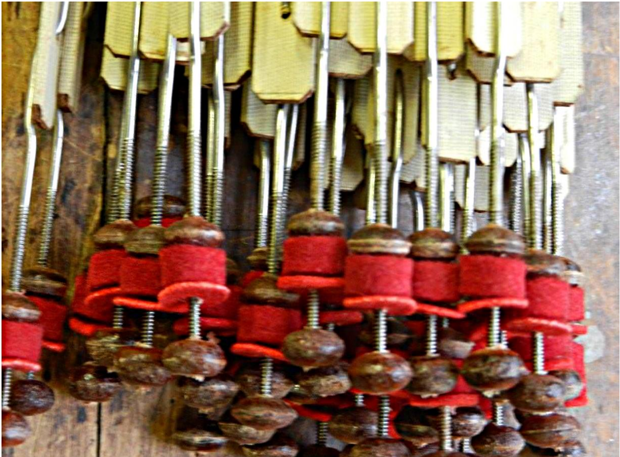
Figuur 34 Vernieuwd draadwerk.
