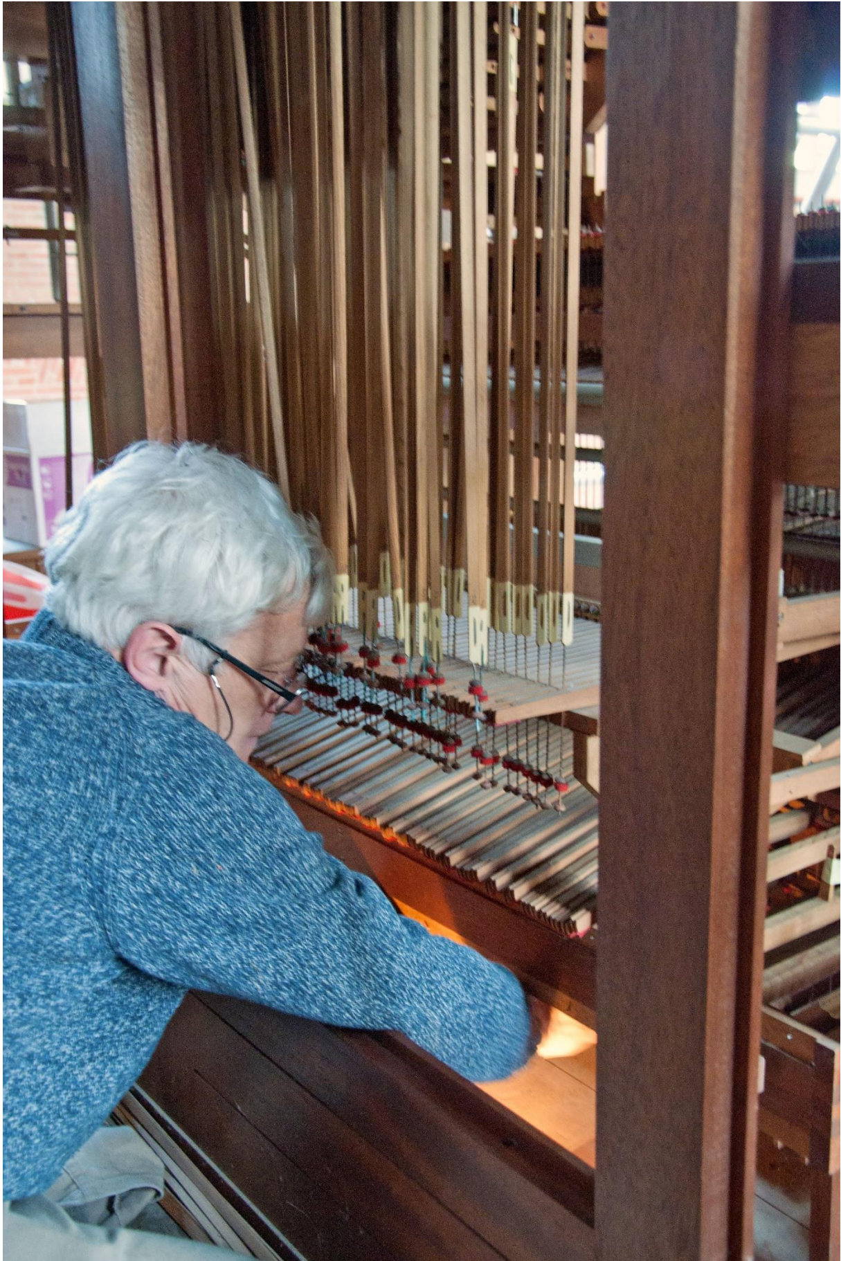
Figuur 15 de speeltafel wordt ontkoppeld
