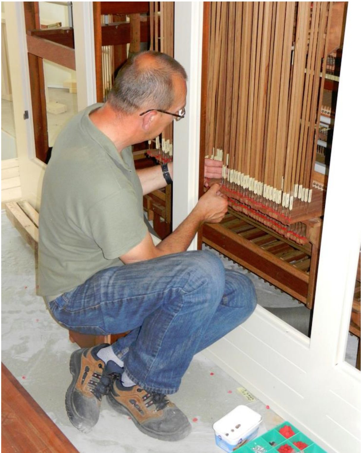
Figuur 45 allen toetsen worden weer aangesloten
