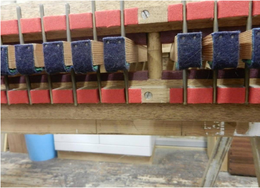
Figuur 38 Vernieuwde invoeringen.
