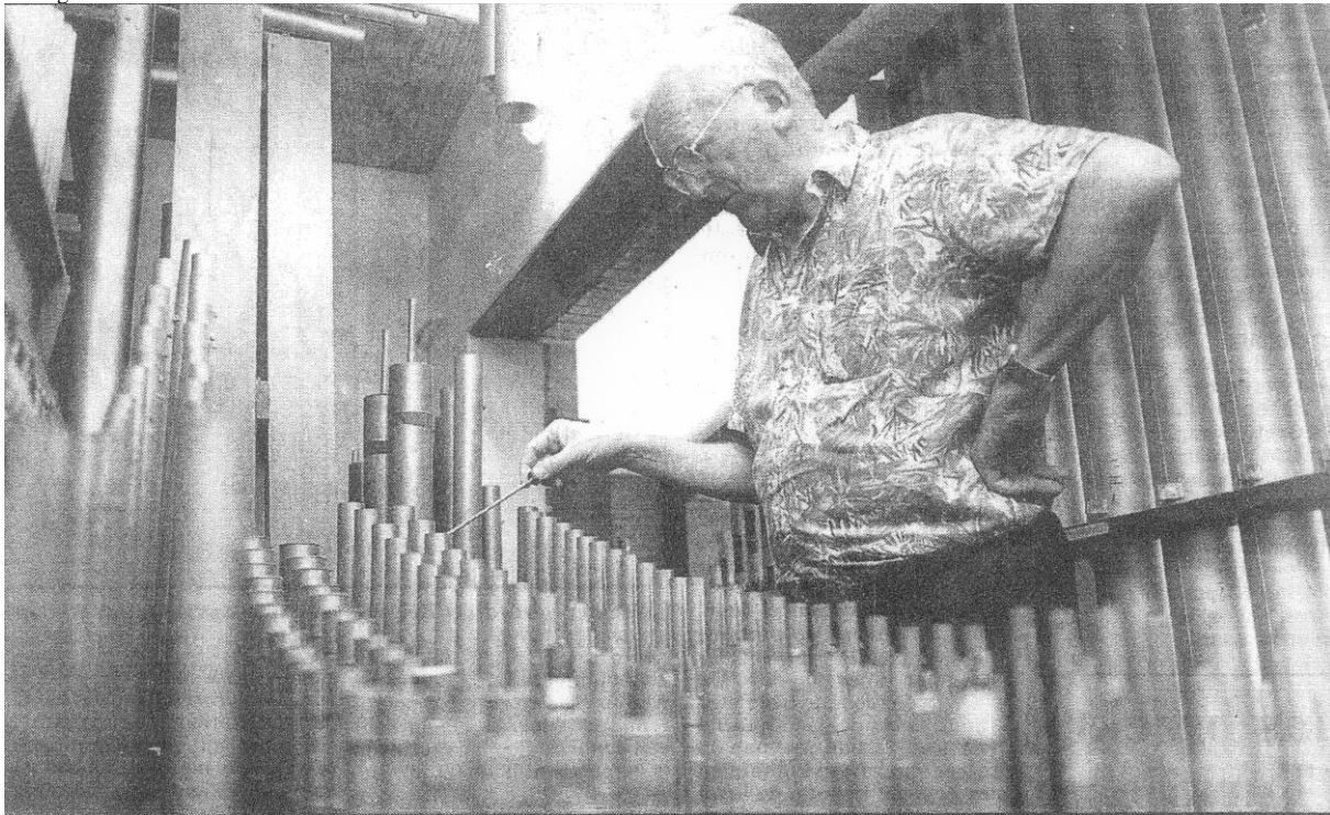
Van der Kuijl in de orgelkast. Het pijpwerk staat overzichtelijk en toegankelijk opgesteld, prettig voor het stemwerk.
